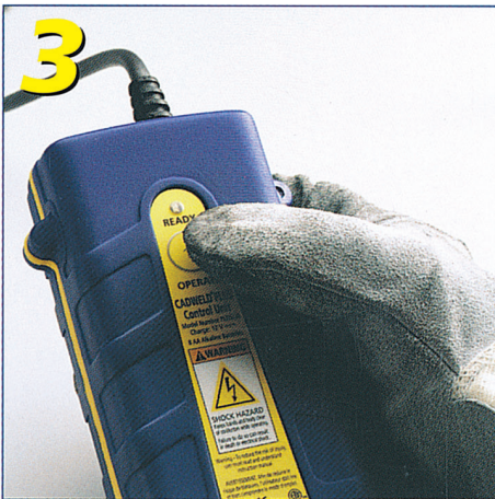
Adım 3: Elektronik ateşleyici düğmesine basılı tutularak ateşleme yapılır.
