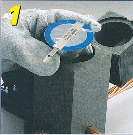
Adım 1: Cadweld Plus ambalajı pota içine yerleştirilir.
