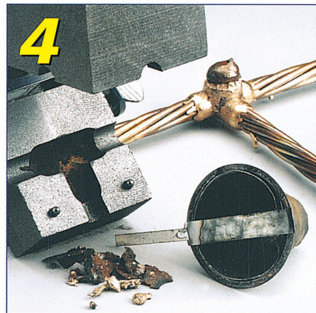
Adım 4: Kaynak soğuduktan sonra pota açılır ve ambalaj şeklindeki cüruf kolayca temizlenir.
